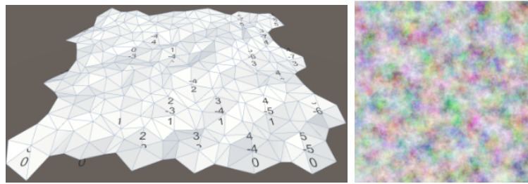
FIGURE 12 – Terrain avec des sommets perturbés (gauche), à l’aide d’une texture de bruit (droite)
