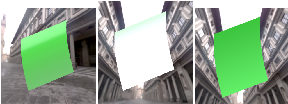
Figure 27: Rendus IBL du modèle dai.bsdf avec une rugosité à 0 pour la surface du dessous. A gauche et au milieu, on se rend compte que la lumière passe à travers. En changeant la rugosité du dessous à 1, la lumière transmise devient diffuse, d'où le fait que la couleur redevienne verte.
