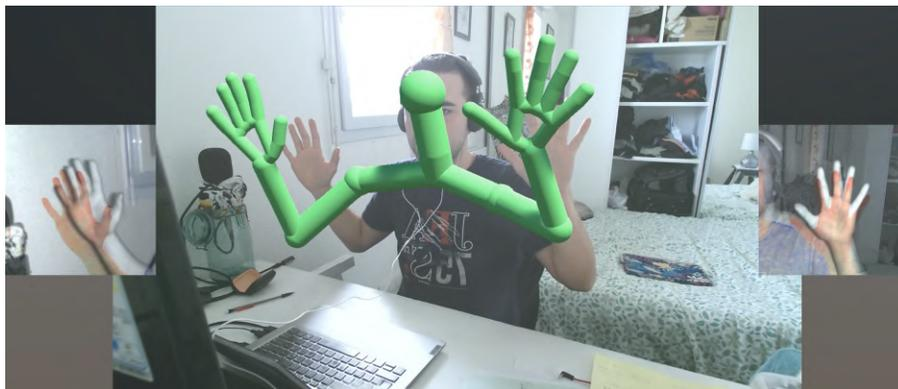
FIGURE 5 – La détection combinée entre la Kinect et HandPoseBarracuda, les images des mains décalées visibles à gauche et à droite.
